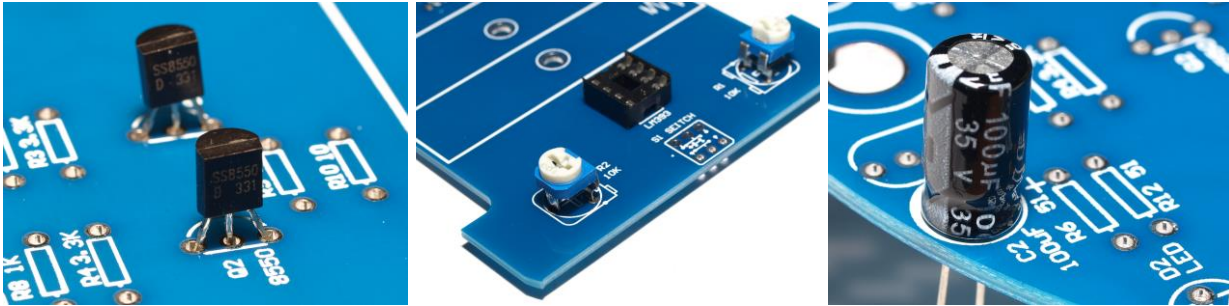
Abbildung 6: Aufbaureihenfolge der Oberseite (unvollständig)
